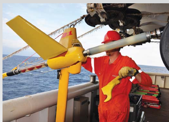
Fig. 3 El sistema Nautilus se despliega fácilmente desde la cubierta trasera del Alizé, ya que las aletas de dirección se insertan directamente en el dispositivo del streamer.
