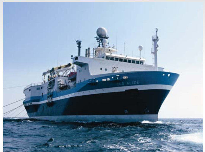
Fig. 1 La embarcación Alizé remolcando 12 "streamers" Sentinel de 8,100 metros de largo cada uno, en la actualidad considerado el objeto en movimiento más grande en el Golfo de México y probablemente en el mundo.
